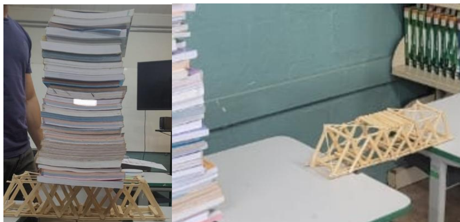
Figura 4 - Teste de resistência da ponte construída pelos alunos do 9º ano.
